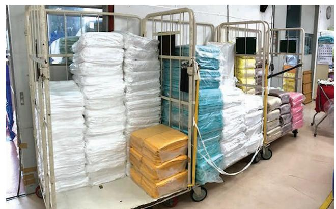
▲自動包装後ワゴンに積み込んだ製品。脱気により荷崩れしない
