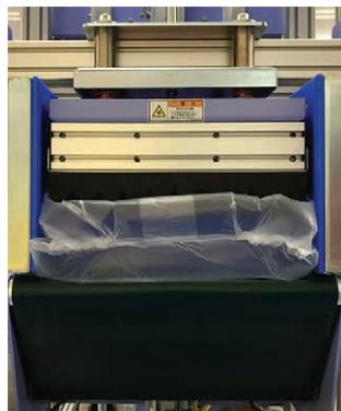
▲上からタオルをプレスして空気を抜き(左)、シール・カットされる
