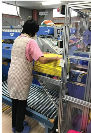
▲タオルを包装機入口にセット(左)。あとはボタンを押して始動するだけ
