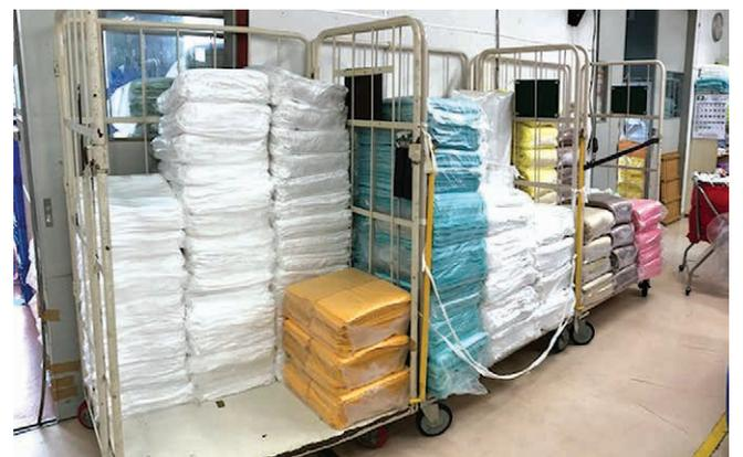
▲自動包装後ワゴンに積み込んだ製品。脱気により荷崩れしない
