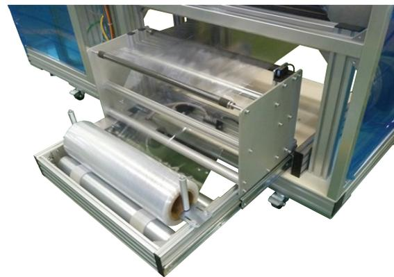
◀フィルム交換部はスライド式で、二つ折りフィルム採用により交換作業も容易
