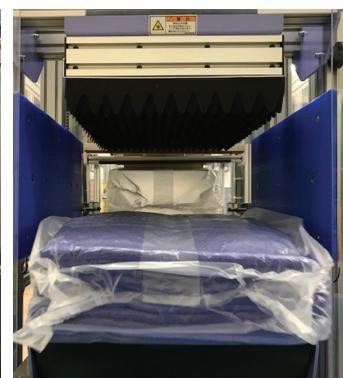
▲上からタオルをプレスして空気を抜き（左）、シール・カットされる
